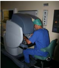
Abbildung 26. Der Operateur sitzt an der Konsole des „Roboters“, und bedient von dort die laparoskopischen Operationsinstrumente.
